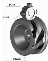
第3回 最優秀賞 「立体カムとローラフォロアの相対運動による包絡面」 香取 英男 佐久田 博司
