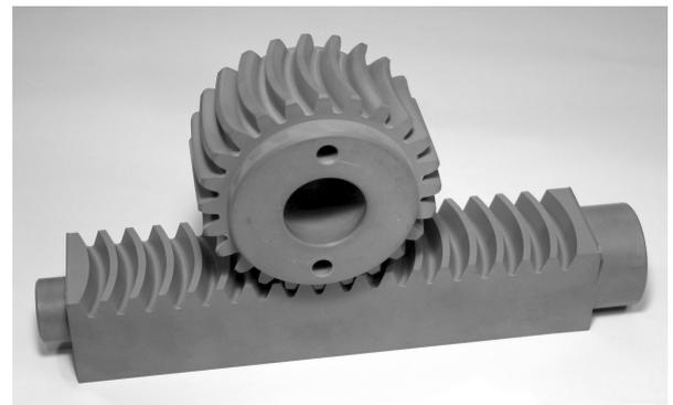
図9 試作した新型の円弧歯すじ歯車
