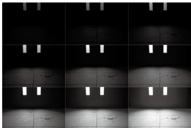
図5 多段階露光で撮影した写真 (露出の異なる複数の画像から撮像系のカメラ応答関数を復元する.)
