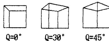
$a = 0, b = 0, c = 0, d = 200, Q = 30^\circ$ として、物体の $x$ 軸回りの回転のパラメータ、 $S$ の値を変化させてみる。
