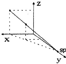
上図のような座標系があり、画面を  $xz$  平面、投影中心を  $y$  軸上の原点から距離  $d$  の位置とする。ここでは物体の変換を以下のように行う。
