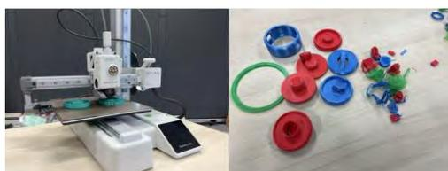
図3・4 出力中のUSBコードケーブルリールと出力に失敗した部品たち
