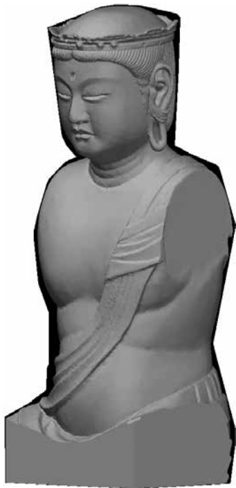
図8 100回目と原本像の形状の比較 (黒部分は100回目と原本像の差分。凹部分に彫り残しが多くみられる。)
