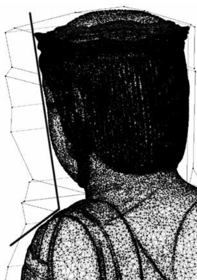
図6 面取りの方法 (輪郭線で形を割り抜いた後、面取りの位置を最初に決定する35回目の工程。3Dデータとの間をわずかに残すように切断線(黒線)を入れて、切断する。)
