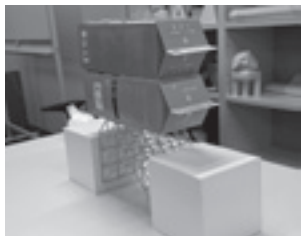
図8-左 条件に違反した例-スパゲティを束で使用
