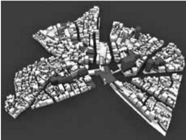
出力サイズ：W300mm×H300mm×H50mm， 素材：エポキシ樹脂，制作：2019年
